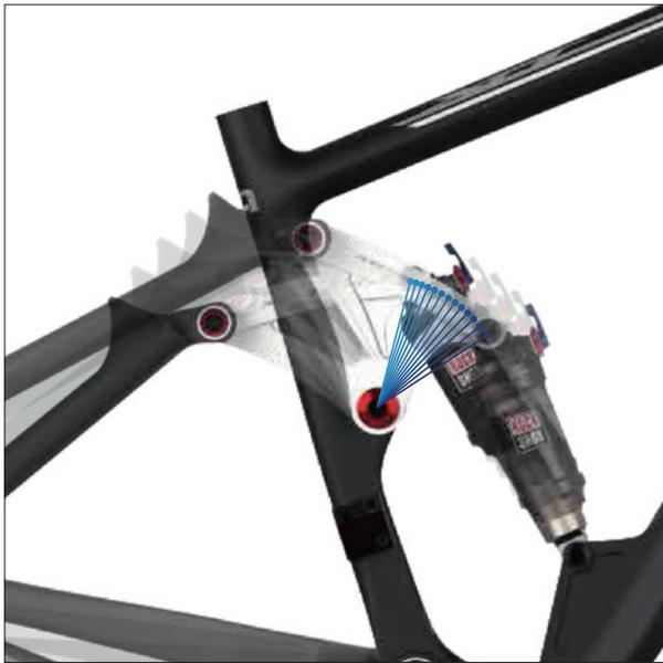
JAMISのリア・サスペンションリンク「MP4」のデザインは、BB軸の中心線の真上と真下にあり、1つのメインピボットに依存しています。すべてはこの1箇所で発生するため、ブレーキングの影響を最小化し、ペダルのキックバック、チェーンのテンションから生じる不要な動作を減少させています。
