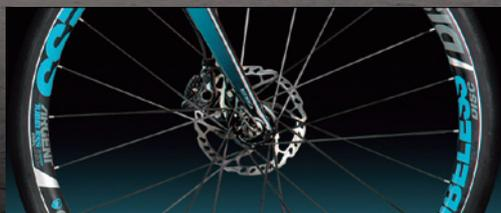
最適なトレール量と快適なポジションを実現するヘッド角を実現させたECOフォーク。また、15mm Thru Axleで剛性が上がり、オフロードでも安定したハンドリングを可能とします。
