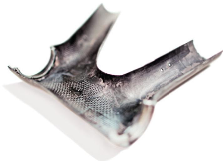
Near Net Molding(ニアネットモールドイング)は、取り外し可能なシリコンの軸を用いて、フレームの主要な部分(ヘッドチューブ、BB、シートチューブ/トップチューブ)をそれぞれ成形します。
