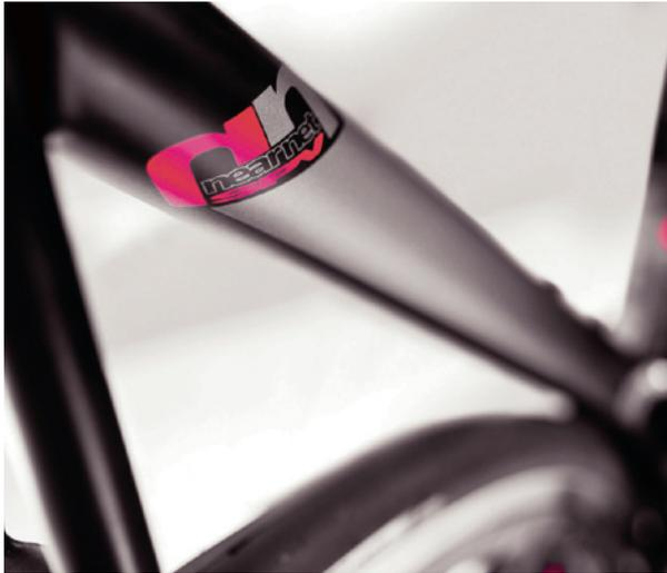
先に述べた「Near Net Molding」に加え、TEAM JAMISに供給されている「XENITH」シリーズにはバキューム（真空成形）を取り入れてます。カーボンシートを重ねて積層になる際に真空状態にすることによって、カーボン積層内にある空気を押し出し均一の積層にするためです。これにより、より軽量に、より強固なカーボンフレームが出来上がるのです。
